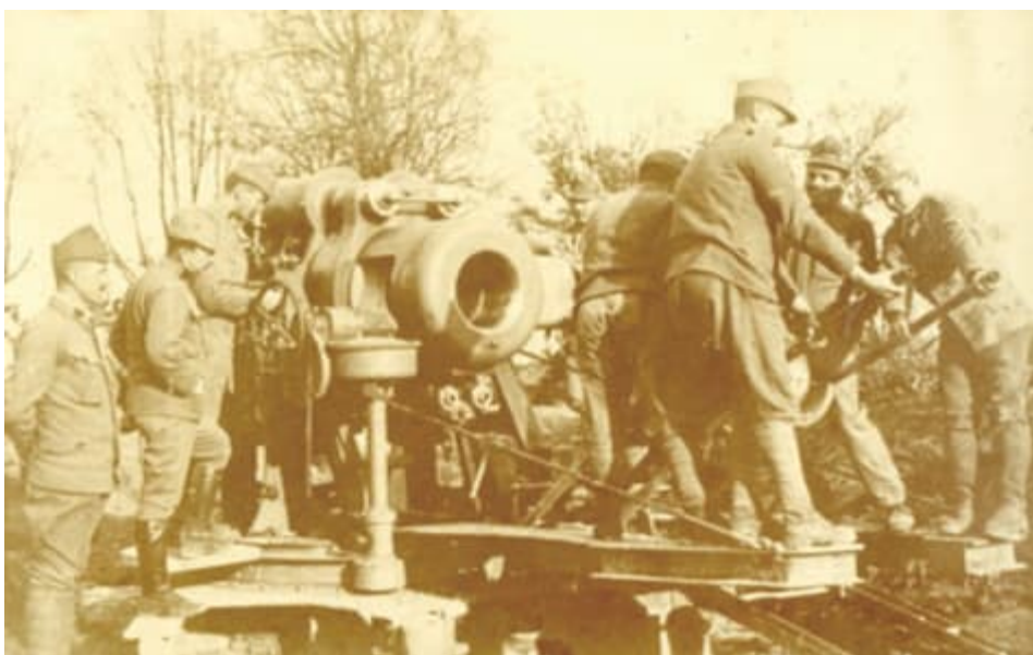
Fotografie ťažkého mažiara vzor 1911 kalibru 30,5 cm vyrobeného v Škodových závodoch. Bola to jedna z najlepších a najslávnejších zbraní rakúsko-uhorskej armády
