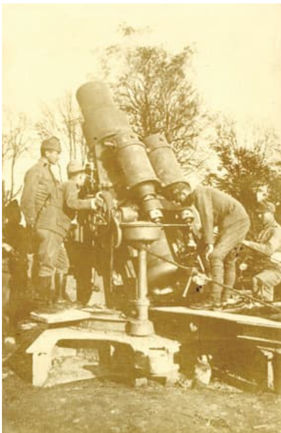
Fotografie ťažkého mažiara vzor 1911 kalibru 30,5 cm vyrobeného v Škodových závodoch. Bola to jedna z najlepších a najslávnejších zbraní rakúsko-uhorskej armády
