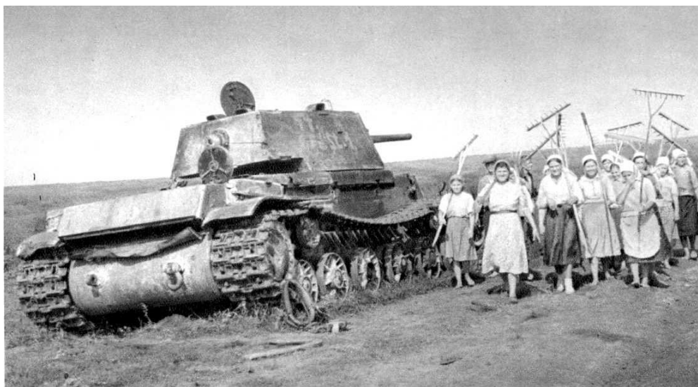
KV-1 vzor 1941 bol vyradený v úseku del. pluku 31 paľbou do podvozku. Tento tank má zjednodušenú a priestranejšiu vežu so silnejším pancierom ako boli pri vzore 1940. V jej zadnej časti vidno tretí guľomet na ochranu zadnej polosféry vozidla. (Od Tatier po Kaukaz)
