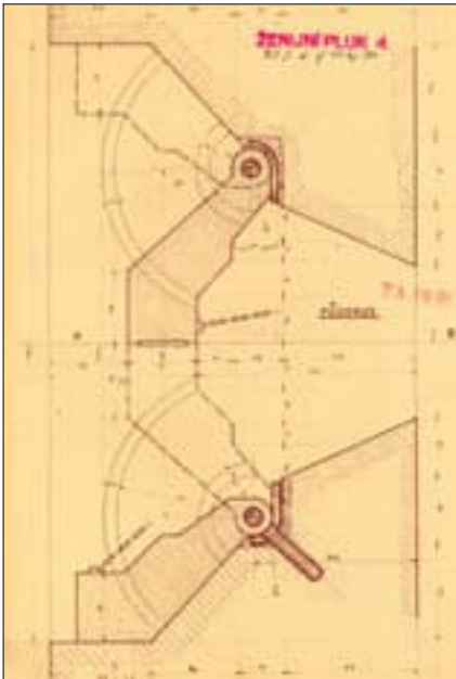
Výkres vrátkového uzávěru navržený Ženíšním plukem 4 v roce 1934. (VÚA-VHA Praha)
