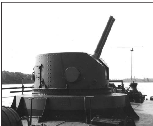
Zadní dělostřelecká věž s dvojkanonem ráže 66 mm, která byla za války nahrazena 88mm kanonem z ponorky. V letech 1949 a 1952 – 1954 se počítalo i s instalací věže z tanku PzKpfw. IV nebo 57mm protiletadlového kanonu R 10 (foto VÚA-VHA Praha)..
