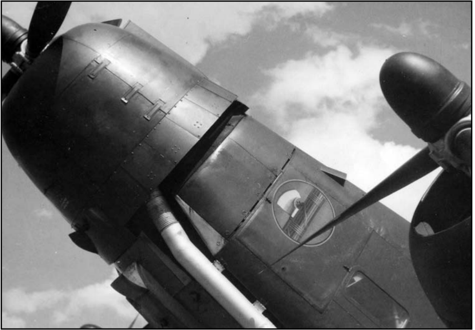
Detailný záber na jednu z trojice pohonných jednotiek lietadla SM-84Bis – motor Piaggio P.XI RC 40bis. Trup lietadla nesie oficiálny znak používaný na označovanie lietadiel kráľovského talianskeho letectva v období rokov 1926 – 1943.
